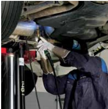
Naprawa zawieszenia rury wydechowej
