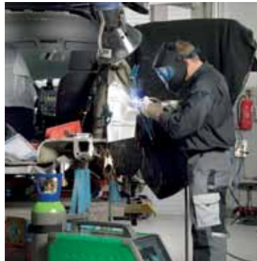
Lutospawanie MIG słupka C
